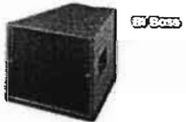
Diffusore acustico due vie per basse frequenze (1x15" caricato su tromba) SPL Max 140dB @1m - Risposta in frequenza 39 Hz / 600 Hz - Binari Flyset per sospensione in dotazione - Connessioni speakon 4 poli - Finitura in moquette antigraffio grigio scura - Dimensioni 688x754xh600 mm - Peso 51 kg
