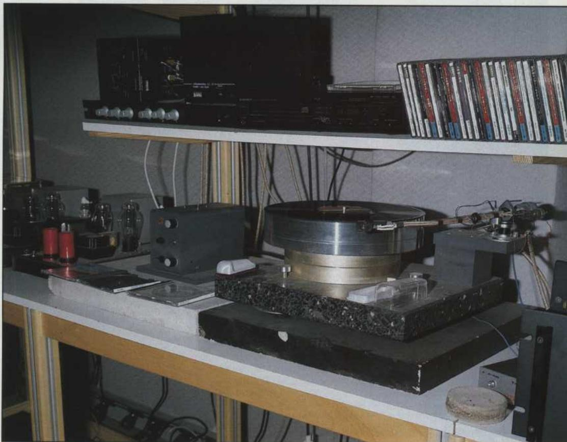
**Maison de l'Audiophile:** Un finale Lectron JH50 pilota la sezione bassi del kit Onken, mentre il mid è affidato a due originalissimi monotriodi da 8 Watt, in classe A pura, con le famose e costose valvole WE 300B. Il tweeter è amplificato da un Hiraga a transistor da 8 Watt, non visibile in foto.
