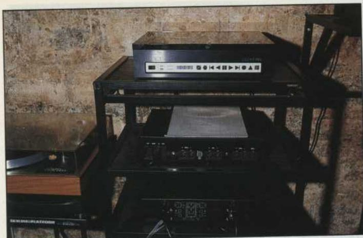
**Audio Synthèse:** Quasi sperduto fra tante elettroniche inglesi questo lettore CD francese Leedh CD-F1 Pro, basato su meccanica ed elettronica Philips, ricorda assai da vicino nell'uso un normale giradischi analogico, con tanto di caricamento dall'alto e stabilizzatore di piombo; in più un'esclusiva sospensione con ammortizzatori pneumatici.
