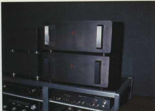
**Soljett:** Belli proprio no, ma rendono bene l'idea... Sono una coppia di finali stereo Helix 2150, in classe A pura e da 150 watt per canale; sono seguiti da altre due versioni, da 100 e 80 watt per canale.
