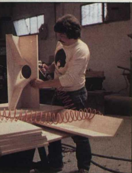
La prima fase del montaggio di una delle otto trombe dei medio-bassi non ne tradisce la complessa struttura, per realizzare la quale sono state superate difficoltà non indifferenti, sia a livello di progetto che di costruzione.
