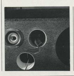
4) Anche (e soprattutto) nella cavità posteriore al mid porremo un lungo cono stipato di lana di vetro, rivolto con la base verso il fondo del tubo (che, ricordiamo, va sigillato) e con il vertice in prossimità del magnete del midrange. Il cono sarà fatto di stoffa leggera, cucita senza eccedere in rifiniture ma curando al meglio lo stipamento dei pezzi di lana di vetro, che deve essere effettuato curando di occupare bene lo spazio senza ammassi o disomogeneità rilevanti.
